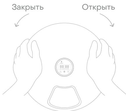
Нажмите на верхнюю крышку ладонями с обеих сторон, а затем поверните ее в направлении нужной стрелки, чтобы открыть или закрыть.
