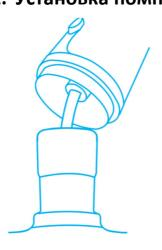
Подсоедините трубку из силикагеля к днищу корпуса помпы. Введите трубку в бутыль с водой и установите помпу днищем на бутыль.
