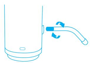
Установите водонепроницаемую муфту из силикагеля на выпускной трубке из нержавеющей стали и прикрутите ее к выходному отверстию помпы
