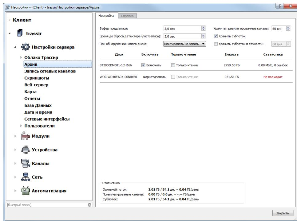
Для этого нажмите кнопку **Форматировать**. По окончании форматирования включится автоматическое использование его для сохранения видеоархива TRASSIR.
