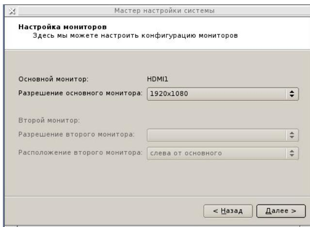
Для каждого подключенного монитора автоматически будет предложено оптимальное разрешение экрана. При необходимости можете изменить этот параметр. Если мониторов несколько, то настройте разрешение каждого и выберите основной. Для остальных укажите расположение относительно основного.
