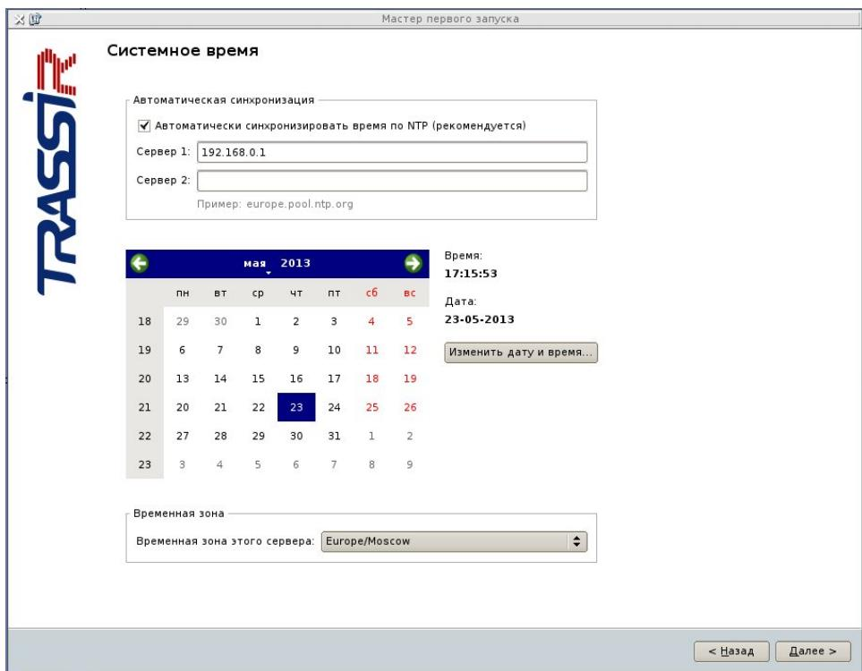
Для автоматической синхронизации времени введите до двух NTP-серверов при этом произойдет попытка синхронизации даты и времени видеорегистратора с одним из NTP-серверов.
